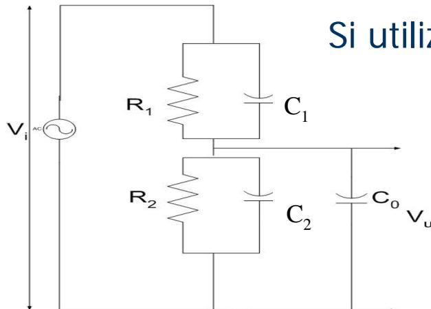
Si utilizzino scale diverse per osservare  $V_i$  e  $V_u \sim 1/2 V_i$
