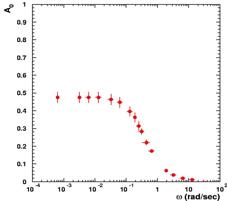
**Osservazione:** il fenomeno di deviazione del rapporto di partizione dal comportamento puramente resistivo (partitore compensato), quindi l'indipendenza del rapporto di partizione da  $\omega$ , dipende dal valore delle resistenze rispetto alle capacità. Noi useremo  $R_1 = R_2 = 100 \text{ k}\Omega$ , mentre le capacità parassite sono dell'ordine di pF  $\Rightarrow 1/(RC)$  è tale da consentirci l'osservazione della decrescita di  $V_u$  con  $\omega$  a partire da  $>10\text{kHz}$ .
